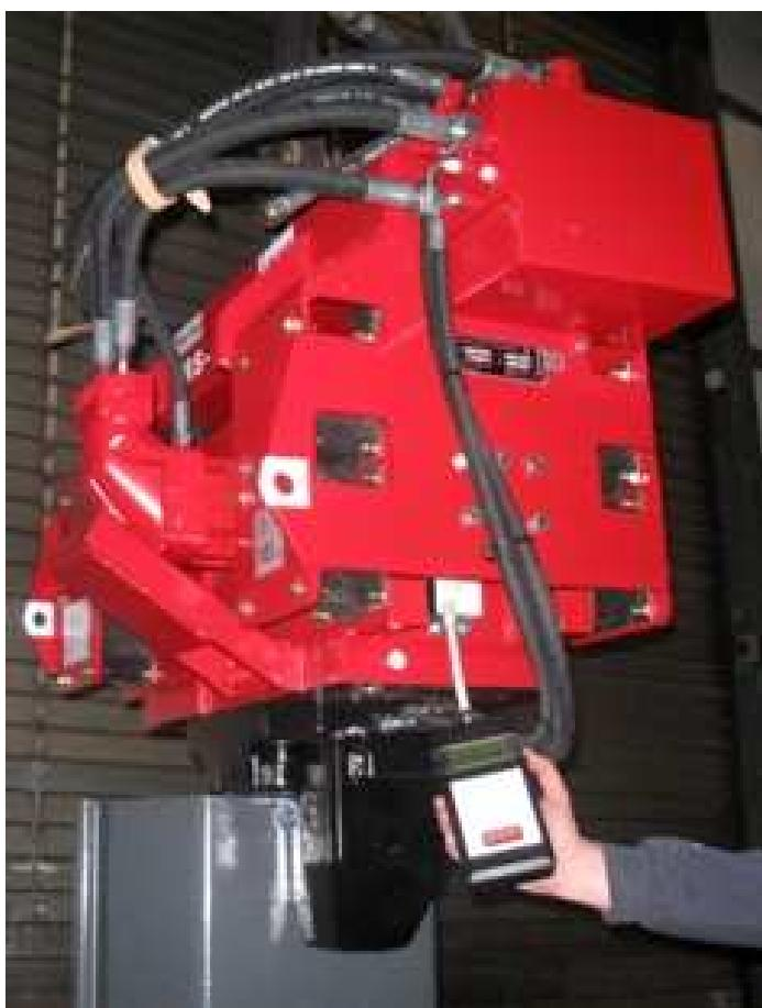
Jedan nedostatak vibratora montiranog na bager bio je otežano praćenje radnih sati ili dana zbog stalne izmjene opreme na bageru.
